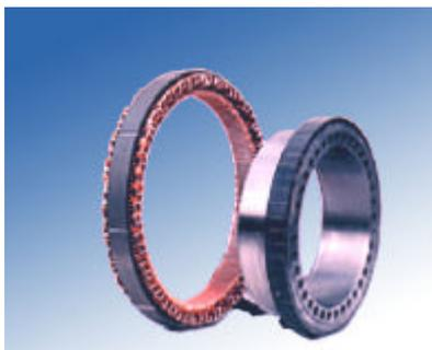
Der fest im Maschinenbett montierte Stator leitet die Wicklungserwärmung nach außen. Durch Vergrößern des Wärmewiderstandes, z.B. Bohrungen im Rotorträger, wird der Wärmeeffluß nach innen zum Werkstück erschwert.
