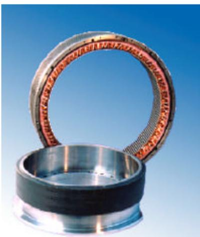
Wassergekühlte Torque-Ringmotoren erhalten ein Statorgehäuse mit Wasserführungsrippen und einen oberen und unteren O-Ring-Einstich zur Abdichtung. Die Wasser-Zu- und Ableitung, sowie die Deckelung der Wasserführung erfolgt durch das Maschinengehäuse
